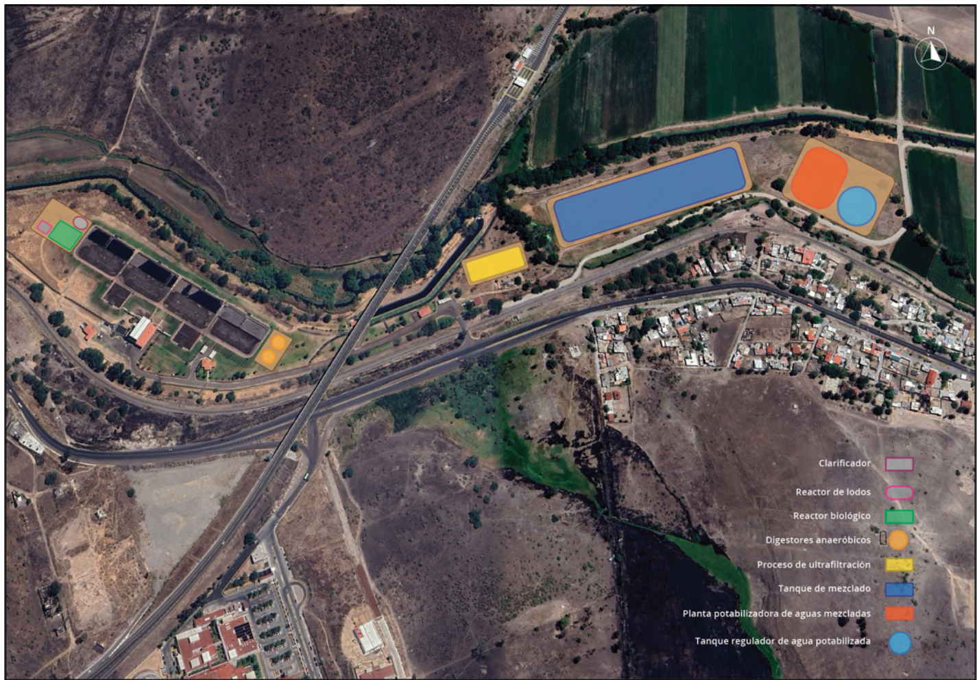
Figura 6.7. Ampliación de la PTAR Atapaneo con potabilizadora de agua mezclada
