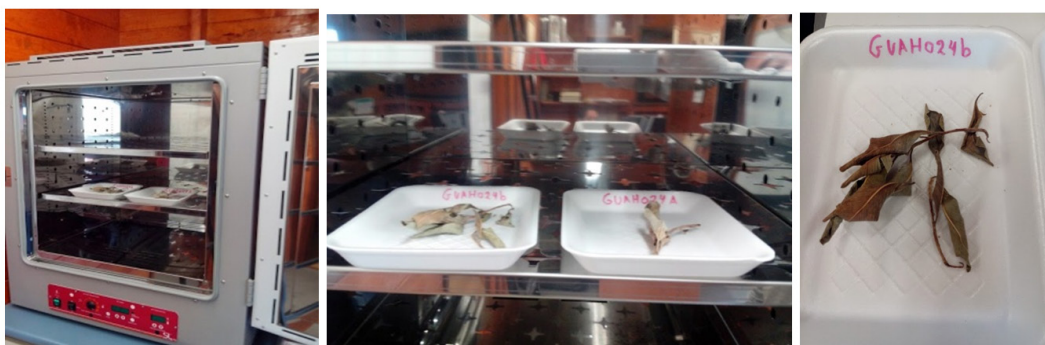
Figura 3.14. Horno eléctrico programable para el secado a 70°C con muestras de hojas.
