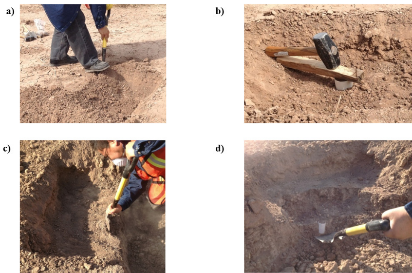
Figura 3.4. Muestreo de suelo control o testigo: a) excavación somera de 20 cm de profundidad; b) procedimiento para toma de muestra; c) excavación más profunda hasta encontrar horizonte subyacente; d) extracción del núcleo.
