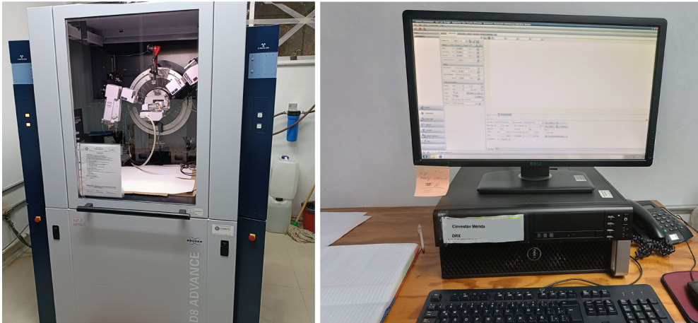
Figura 6.9. Equipo y computadora para analizar los patrones de difracción con la base de datos que contiene los patrones de difracción publicadas por la ICDD (Fotos de José Luis Cortés Esquivel).
