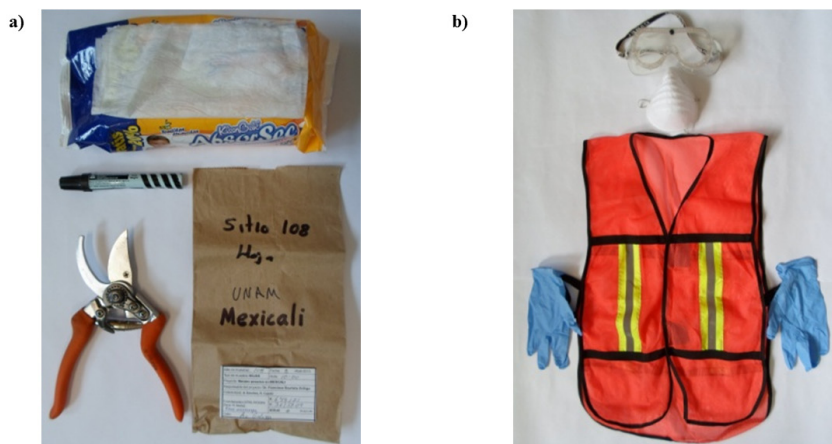
Figura 3.7. Materiales para el muestreo de hojas de plantas: a) material de recolección, empaquetado y limpieza; b) material de seguridad personal.
