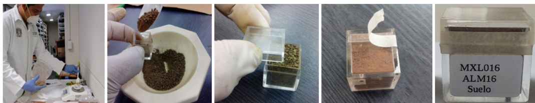
Figura 3.15. Procedimiento de encapsulado de muestras de suelo y polvo urbano (Imagen propia y Cejudo, 2018).
