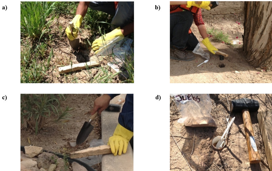
Figura 3.3. Muestreo de suelo superficial: a) limpieza de la superficie del sitio a muestrear; b) procedimiento para toma de muestra; c) extracción del nucleador con pala de jardinería; d) extracción de suelo al interior del núcleo con cuchara de plástico.
