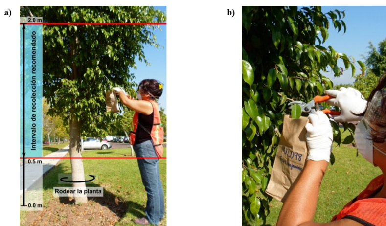
Figura 3.9. Muestreo de hojas de plantas: a) procedimiento de recolección; b) detalle del corte en el pecíolo de la hoja.
