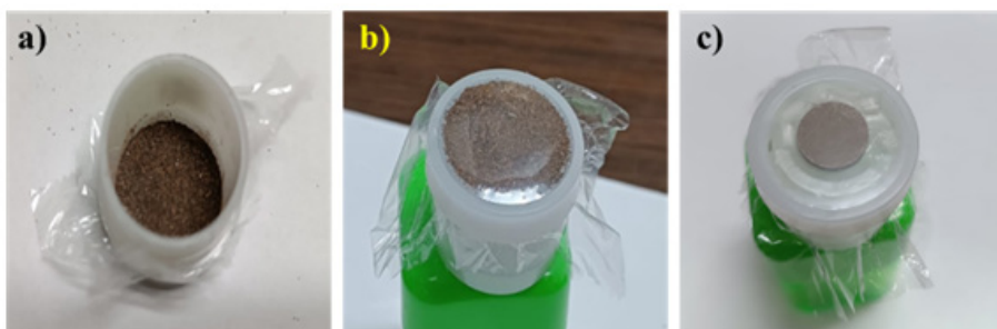
Figura 4.4. Tratamiento de la muestra para ser analizada por FRX: a) Polvo sin tratamiento; b) pastilla en forma de perla; c) pastilla prensada (Fotos de José Luis Cortés Esquivel).
