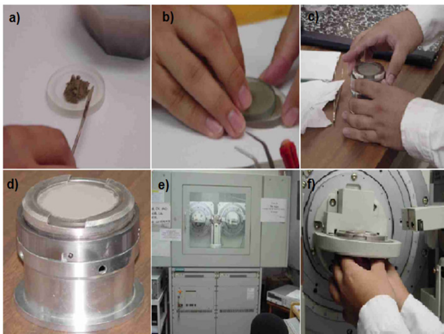
Figura 6.6. Tratamiento de la muestra para su medición: a) distribución de la muestra en el portamuestras, b) fijación de muestra, c) colocación de la muestra en el portamuestras, d) portamuestras, e) equipo de DRX, f) colocación de la muestra en el equipo (Fotos de José Luis Cortés-Esquivel).
